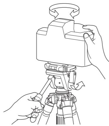
カメラ台固定レバーをゆるめるとカメラ台はフリーになり、360°回転します。
