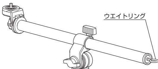
雲台の位置、搭載機材の重量、アームの長さにより重心位置が変わり、三脚が倒れやすくなる可能性があります。
