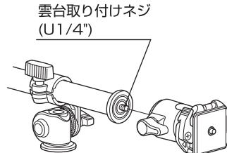
スライドアーム先端には別売の雲台（アクセサリー）を取り付けることができるU1/4"雲台取り付けネジが付属しています。
