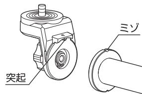
アングルアダプターを取り付けるときは、アングルアダプター取り付けノブを時計まわりに回して締め付けます。このとき、アングルアダプターの突起部と、座金のミゾを合わせてください。
