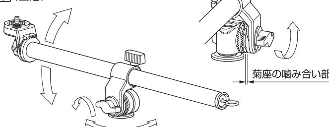
角度調節ノブを反時計まわりに回してゆるめるとスライドアームの角度調節と水平方向に回転させることができます。このとき、菊座の噛み合い部が完全に離れるまでゆるめてください。
