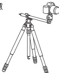
一方方向へ雲台とアームを伸ばした状態で使用する際は、三脚が倒れやすくなってしまい、大変危険です。三脚の一本の脚をスライドアームと同じ向きにしてご使用ください。
