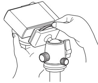
カメラの三脚取り付けネジとカメラ台のカメラネジを合わせて、カメラ締め付けダイヤルを回し、しっかりと固定します。
