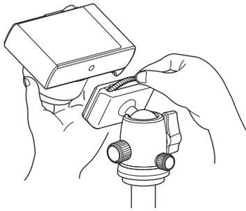
ボールロックレバーを操作して図のようにカメラ台を傾けると、ネジ部が見えて取り付けやすくなります。
