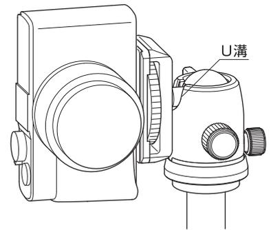
カメラ台をU溝に倒し込むことでカメラを縦位置にセットできます。
