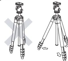
カメラの取り付け、ハンドル、ツマミ、レバー類のロックは確実に行って、落下や転倒を防いでください。また、3本の脚を十分に開いてください。脚の開きが不十分だと不安定でカメラブレや転倒の原因になります。
