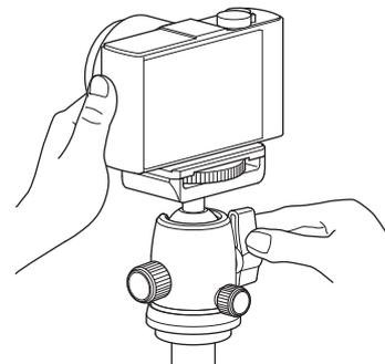
カメラを取り付けた状態でボールロックレバーをゆるめると、カメラが急に倒れることがあります。ボールロックレバーをゆるめたときは、固定するまでカメラをしっかりと支えてください。
