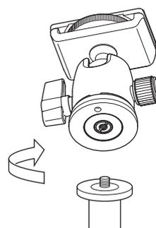
雲台の三脚取り付けネジと三脚の雲台取り付けネジを合わせて、雲台を時計方向に回し、しっかりとねじ込みます。
