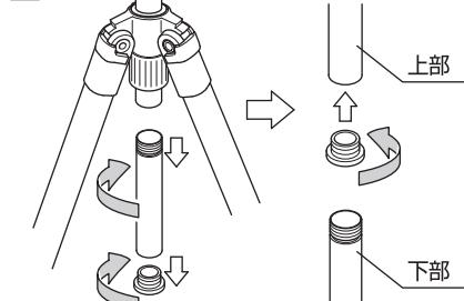
エレベーター抜け止めと、エレベーター下部を矢印の方向にねじって取り外します。
