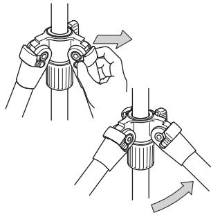
標準の開き位置から脚を少し閉じるようにして、開脚ストッパーを引き出すと残り二つの開脚角（ミドル、ローポジション）がえらべます。
