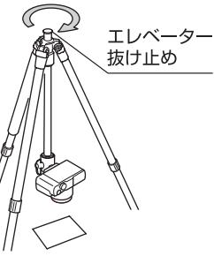
③ エレベーター抜け止めを外し、エレベーターを抜きとります。
