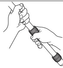
脚ロックナットを増し締めるときなど力強く締め込むときは、1段上のパイプを持って締め込んでください。
