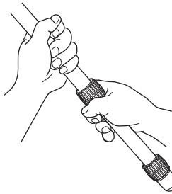
脚ロックナットをゆるめると、脚は伸縮します。位置がきましたら、しっかりと脚ロックナットを締めつけてください。
