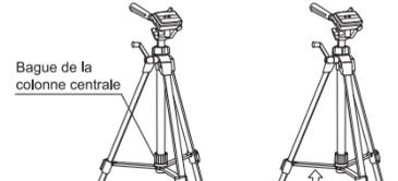
En tenant deux pattes, une dans chaque main, basculez le trépied sur sa troisième patte. Tirez les deux pattes que vous tenez vers l'extérieur, et les trois pattes s'ouvriront en même temps. Ouvrez jusqu'à ce que la bague de la colonne centrale repose tout en bas de celle-ci.
