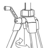
Utilisez le tube de réglage de la tension de la colonne centrale situé autour de celle-ci si vous souhaitez régler la tension du mouvement de la colonne centrale.
