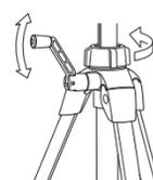
Desserrez le collier de verrouillage de la colonne centrale en le tournant dans le sens antihoraire et tournez la manivelle pour élever ou abaisser la colonne centrale.
