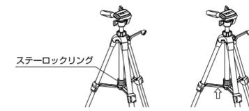
ステアがカバーパイプの下端にあたるまで一杯に開いてください。ステアロックリングを占めるとより安定します。閉じるときはステアロックリングをゆるめ、ステアの下端に手を当てて、少し上に持ち上げると閉じられます。
