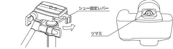
シュー固定レバーを起しながらクイックシューを取り外します。ビデオボスが沈下式のためビデオカメラ、スチルカメラどちらにも使えます。シューの方向を合わせ、しっかりと締め付けます。締め付けいたらツマミを倒します。ビデオカメラの場合はボス穴とボスを一致させて、取り付けてください。雲台にシューを戻し、レバーでしっかりと締めこみます。
