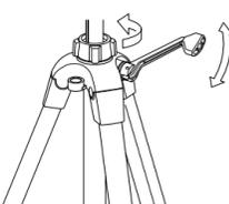
Entriegeln Sie die Mittelsäulen-Arretierung durch Linksdrehung wie im Bild und kurbeln Sie dann die Kurbel nach Bedarf hoch oder wieder zurück.
