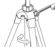
Der Reibungswiderstand beim Verschieben der Mittelsäule lässt sich durch veränderbare Klemmung Ihren Wünschen anpassen, wenn Sie (bei gelöstem Beinstreben-Arretierriem) das Mittelsäulenrohr verdrehen. Drehen Sie für stärkere Klemmung nach links und für schwächere nach rechts.
