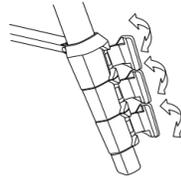
Klappen Sie die Beinauszugsclenken auf, um die Segmente eines Stativbeins auf die gewünschte Gesamtlänge herausziehen oder sie wieder einschieben zu können. Zum Arretieren im ausgezogenen oder eingeschobenen Zustand drücken Sie die Klemmen wieder fest an das Stativbein. Wenn Sie nicht die volle Länge benötigen, ziehen Sie für beste Stabilität immer zuerst die dicksten Segmente heraus.
