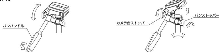
ビデオにもスチルにも使える 3 動作分離雲台です。パンハンドルをゆるめるとティルト（前後）、バンストッパーをゆるめるとパンニング（左右）できます。スチルカメラの縦位置撮影は、カメラ台ストッパーをゆるめ、カメラ台をたてて行います。
