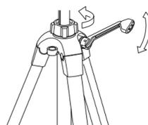
エレベータ締め付けナットをゆるめクランクハンドルを操作すると、エレベータを上下できます。クランクハンドルから手を離す前に締め付けナットをしっかりロックしてください。
