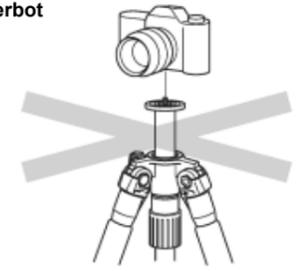
Schrauben Sie die Kamera nicht direkt auf die Stativkopfschraube. Dadurch können sowohl die Kamera als auch das Stativ beschädigt werden.
