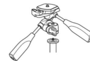
Entfernen Sie zunächst den Stativkopf, bevor Sie die Mittelsäule umdrehen oder austauschen.
