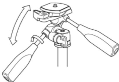
Lösen Sie den Schwenkhebel, wodurch sich der Stativkopf vor und zurück bewegen lässt.
