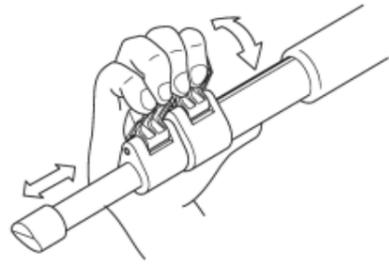
Klappen Sie den Stativbein-Verschlusshebel nach oben, um die jeweilige Stativbeinsektion auf die gewünschte Länge hinein- oder herauszuschieben und klappen Sie den Fixierhebel komplett zurück, um ihn zu arretieren.
