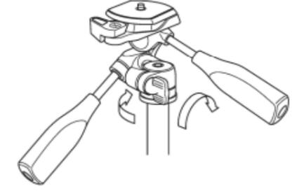
Setzen Sie den neuen Stativkopf oder Zubehör auf das Gewinde der Mittelsäule und drehen Sie ihn bzw. es im Uhrzeigersinn bis zum Anschlag. Drehen Sie den Schwenkarretierungsknopf ein wenig im Uhrzeigersinn weiter.
