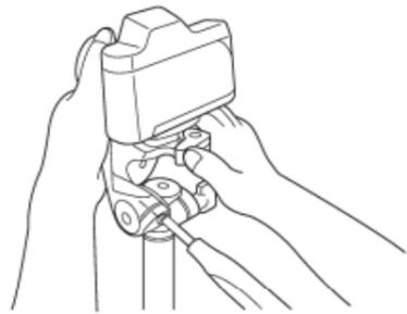
Wenn Sie eine Kamera am Stativkopf befestigen, überprüfen Sie, ob die Schellkupplungsplatte im Stativkopf eingerastet ist, bevor Sie den Hebel arretieren.
