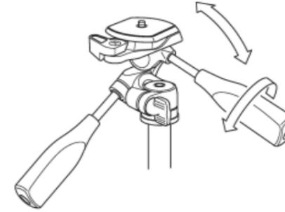
Lösen Sie den Vertikalneigungshebel, woraufhin sich der Level einstellen lässt.
