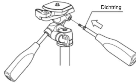
Stellen Sie sicher, dass sich auf der Welle des Vertikalneigungshebels ein Dichtring befindet und schrauben Sie anschließend den Hebel in das Gewinde auf der rechten Seite des Stativkopfs. Schrauben Sie den Griff vollständig in das Gewinde, bis er fest sitzt.
