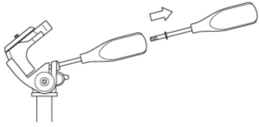
Nehmen Sie den Vertikalneigungshebel vom hinteren Teil des Schwenkhebels ab.
