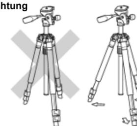
Um ein Herunterfallen des Equipments oder ein Überkippen des Stativs zu verhindern, stellen Sie sicher, dass sämtliche Hebel, Feststellschrauben und Griffe am Stativ festgezogen sind. Außerdem sollten alle drei Stativbeine komplett ausgezogen sein.
