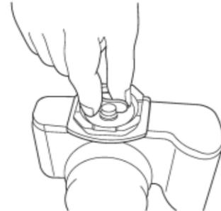
Richten Sie den Kameraträger an der Unterseite der Kamera aus und ziehen Sie die Sicherungsflügelmutter fest.
