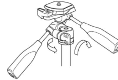
Gehen Sie wie folgt vor, um den Stativkopf auszutauschen oder Zubehör anzubringen. Ziehen Sie zunächst den Schwenkarretierungsknopf fest, greifen Sie den Schwenk- bzw. Vertikalneigungshebel und drehen Sie den Stativkopf entgegen dem Uhrzeigersinn, um ihn zu lösen.
