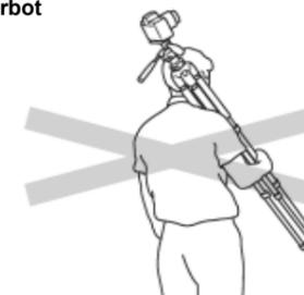
Beim Transportieren bzw. Tragen des Stativs mit angebrachter Kamera kann es zu Unfällen kommen. Aus diesem Grund wird empfohlen, die Kamera vorher abzunehmen.
