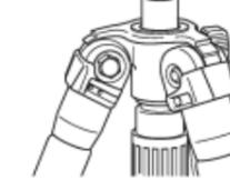
Setzen Sie die neue Mittelsäule von oben ein und ziehen Sie den Klemmring fest. Bringen Sie stets den Mittelsäulen-Abschlusspfropfen am unteren Ende der Mittelsäule wieder an, da dieser verhindert, dass die Mittelsäule unabsichtlich herausgezogen werden kann.
