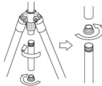
Entfernen Sie den Mittelsäulen-Abschlusspfropfen und danach den unteren Teil der Mittelsäule.
