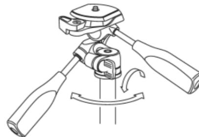
Lösen Sie den Schwenkarretierungsknopf, woraufhin sich der Stativkopf in horizontaler Richtung drehen lässt.
