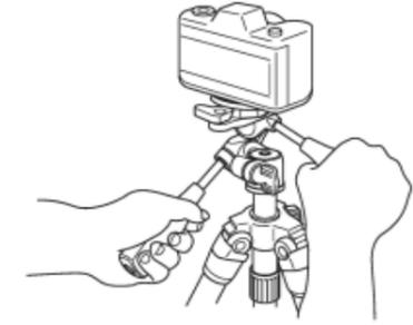
Wenn Sie entweder den Schwenkhebel oder den Vertikalneigungshebel lösen, halten Sie den jeweiligen Griff fest, bis der Stativkopf fixiert ist.
