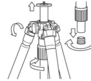
Ziehen Sie den Mittelsäulen-Abschlusspfropfen aus dem unteren Ende der Mittelsäule. Entfernen Sie den Verschlusspfropfen der Mittelsäule sowie den Klemmring und ziehen Sie die Mittelsäule heraus.
