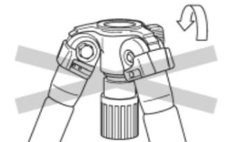
Drehen Sie den Abschlusspfropfen der Mittelsäule nicht, während keine Mittelsäule und/oder optionale kurze Mittelsäule eingesetzt ist. Die inneren Teile könnten beschädigt werden.
