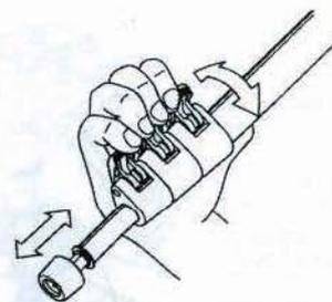
Öffnen Sie die Verschlusshebel um die Beine ein- oder ausziehen. An der gewünschten Position fest verriegeln. Beim ausziehen, die größeren Beine zuerst.
