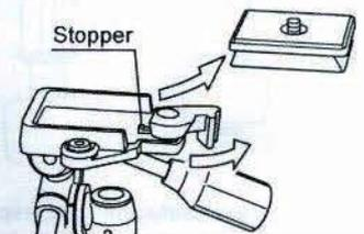
Entfernen Sie die Schnellkupplungsplatte, indem Sie den Verschlusshebel drehen. In diesem Fall bitte den Verschlusshebel nicht mit Gewalt zurück stellen, da dieser gegen den Stopper steht.
