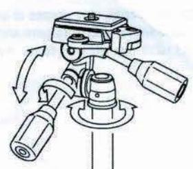
Wenn Sie den Kopf-Schwenkhebel (länger) lockern, lässt sich der Kopf nach vorne und hinten schwenken. Im selben Zuge dreht er sich auch horizontal.
