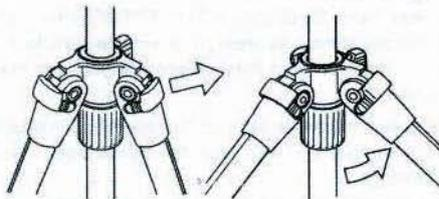
Um den Winkel jedes Beines einzustellen, schließen Sie diese etwas zusammen und lösen Sie dann die Beinwinklereinstellverschluss. Es gibt zwei Winkelpositionsauswahlmöglichkeiten.
