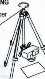
Dies kann für die Reproduktions- und/oder Nahaufnahmen Fotografie verwendet werden. Entfernen Sie den Mittelsäulen Base Stopper. Lösen Sie den Mittelsäulenstopper und Mittelsäulenverschluss. Setzen Sie die Mittelsäule von unten ein und verschließen Sie fest alle Mittelsäulenverschlüsse. Um Fallschäden zu vermeiden, bringen Sie bitte unbedingt auch den Mittelsäulen Base Stopper wieder an!
