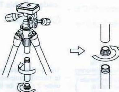
Entfernen Sie den Mittelsäulenstopper und dann den unteren Teil der Mittelsäule. Setzen Sie den Mittelsäulenstopper auf das Ende des oberen Teils der Mittelsäule.
