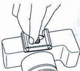
Richten Sie Schnellkupplungsplatte entlang der Unterseite des Kameragehäuses aus und ziehen Sie die Montageflügelschraube fest.
