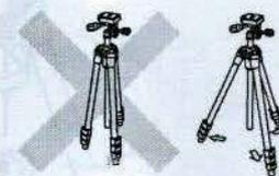
Verhindern Sie ein versehentliches umkippen des Statives, indem Sie vorher sicherstellen, dass alle Hebel, Drehknöpfe und Griffe an dem Stativ festgezogen und alle drei Beine vollständig geöffnet sind.
