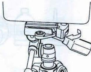
Wenn Sie die Schnellkupplungsplatte an dem Kopf befestigen, stellt sich der Verschlusshebel automatisch zur Ausgangsposition zurück. Wir empfehlen jedoch, den Hebel zur Sicherheit der Fixierung zusätzlich etwas mehr festzuziehen.
