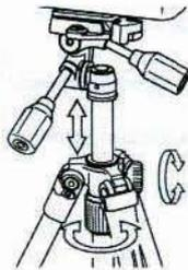
Lösen Sie den Mittelsäulenstopper in dem Sie den Kopf festhalten und lösen Sie dann den Mittelsäulenverschluss. Nachdem Sie die gewünschte Höhe eingestellt haben stellen Sie, bevor Sie den Kopf los lassen, den Mittelsäulenstopper und den Mittelsäulenverschluss fest.
