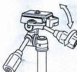
Lockern Sie den vertikalen (kürzeren) Schwenkhebel und der Hebel kann eingestellt werden.
