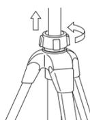
Desserrez le collier de verrouillage de la colonne centrale en le tournant dans le sens antihoraire. Soulevez la colonne centrale à la hauteur souhaitée, puis verrouillez en tournant le collier dans le sens horaire.
