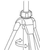
Utilisez le tube de réglage de la tension de la colonne centrale situé autour de celle-ci si vous souhaitez régler la tension du mouvement de la colonne centrale.
