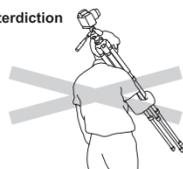
Si vous laissez l'appareil photo sur le trépied pendant que vous le transportez, il pourrait survenir des accidents. Par conséquent, nous vous recommandons d'enlever l'appareil photo avant de transporter le trépied.
