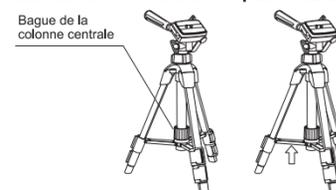
En tenant deux pattes, une dans chaque main, basculez le trépied sur sa troisième patte. Tirez les deux pattes que vous tenez vers l'extérieur, et les trois pattes s'ouvriront en même temps. Ouvrez jusqu'à ce que la bague de la colonne centrale repose tout en bas de celle-ci.
